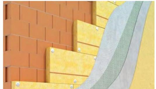
fig. 1 - layering del sistema d'isolamento "a cappotto"
